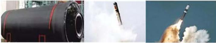
中国航天科技集团研制200吨推力先进固体火箭发动机地面热试车获得圆满成功, 标志着中国固体火箭发动机技术又向前迈进了一大步。从相关资料来看, 国产200吨推力固体火箭发动机直径为2.65米, 装药71吨, 太阳同步轨道运载能力为1.5吨, 它采用了多项先进技术, 综合性能达到当今一流水平。在国产200吨推力固体火箭发动机采用多项先进技术这其中有一项最为引人注目, 那就是大直径碳纤维缠绕复合材料壳体技术, 这应该是中国第一次公开已经掌握大型固体火箭发动机碳纤维缠绕复合材料壳体技术, 众所周知, 固体火箭发动机壳体也是导弹壳体, 它的工作环境极为恶劣, 包括发动机工作产生的高温、高速飞行产生的气流冲击、温度骤然变化、对方反导拦截武器攻击等等, 因此要求发动机壳体具备良好的耐高温、耐腐蚀、强度高、抗冲击等方面性能。
