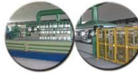
左: 2张图片为高压玻璃钢(GRE)管道和埋地电缆管道生产线,
