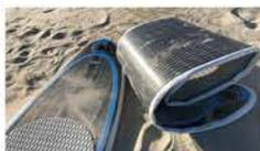
空气芯复合材料是一种以TenCate公司的Cetex TC940(PET)为基材材料的碳纤维增强层压板,该材料是一种连续纤维增强热塑性复合材料(CFRT)。这些层压板可以热粘合到聚合物涂层充气膜上,并通过优化任何可展开的便携式结构的应力或载荷要求,为任何用途定制。增强的刚性提供了显著改善的性能,堆装包装尺寸减少,更快的部署能力和结构附着点。(来源:Inflatablecomposites)
