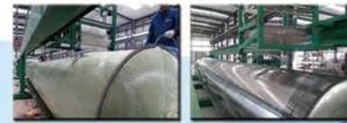
左: 2张图片为聚氨酯复合材料杆塔生产线
