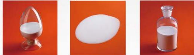
空心玻璃微珠是一种微米级的表面光滑的中空玻璃微球，主要化学成分为碱石灰硼硅酸盐玻璃，电镜下观察为空心透明圆球体。空心玻璃微珠具有耐高温、耐磨损、低导热、电绝缘、质轻、高强度等多种性能，具有良好的流动性和化学稳定性，是理想的多孔材料。
