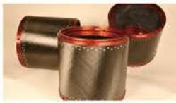
一种热塑性复合材料组件，它取代了纯金属的一级结构，并通过定制的热力学性能减轻了重量。探空火箭的初级结构：热塑性复合构件取代纯金属一级结构采用碳纤维增强热塑性塑料(CF-PEEK)带的纤维自动放置(AFP)工艺制造了探测火箭任务的主要结构。该部件取代了传统的金属部件，从而促进了复合材料在空间应用中的更多使用。与其他使用热塑性塑料的 AFP 工艺不同，不需要进行后固结工艺来确保结构的完整性。这种单步(原位)制造方法长期以来一直是热塑性塑料领域的目标，消除了昂贵和耗时的真空装袋工艺。与绕线工艺相比，用于生产这种组件的方法也显示出明显的优势，在绕线工艺中，粗纱交叉会导致纤维波动，从而降低刚度和强度。反而获得了良好的几何公差和层间胶结质量。
