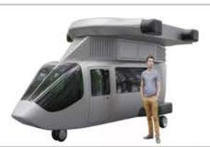
据ainonline网站2018年11月19日报道，德国初创垂直起降（VTOL）飞机制造商JETcopter公司现已完成7座双发垂直起降飞机设计方案。
