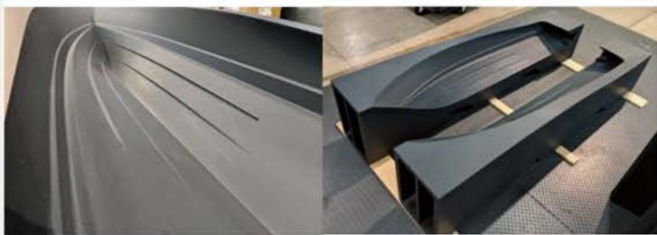
赛姆伍德已经打印了一个全尺寸的图案，用于生产运动艇壳模具。大得多的船只，例如游艇，需要一种不同的方法。在这些情况下，最好是打印模具本身，而不是打印一个插头或图案的模具。
