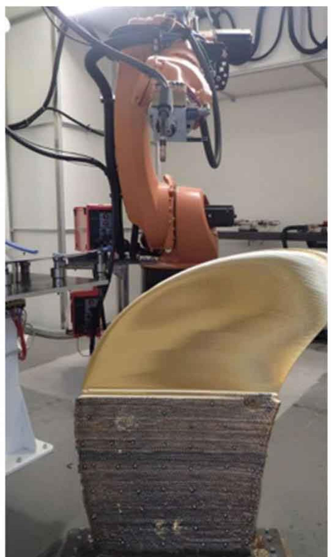
Naval Group和Centrale Nantes已经使用增材制造印刷了第一个用于军事应用的全尺寸螺旋桨叶片演示器。在2016年启动的海洋技术联合实验室的框架内，海军集团和Centrale Nantes团队印制了一个重量超过300千克的大型几何复杂螺旋桨叶片。
