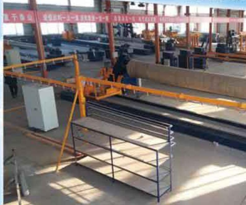
直径3米玻璃钢夹砂管道生产线
