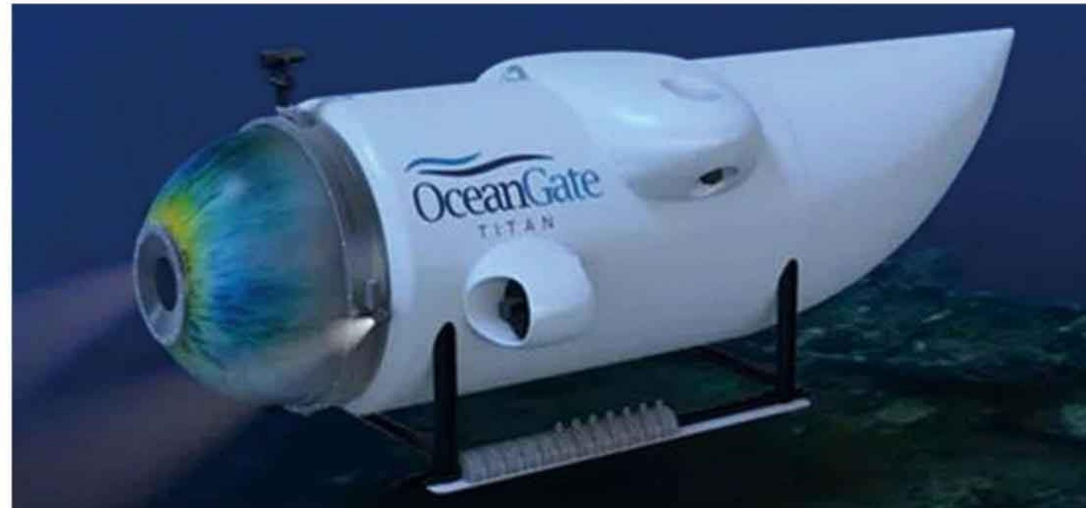
作为泰坦号水下测试计划的一部分，OceanGate团队进行了一系列无人驾驶潜水测试。将潜水器逐渐降低至4000米的同时在另外一条船上使用应变仪、视口位移传感器和定制设计的声学传感器系统测量船体的健康状况，提供潜水器下潜过程中和两次过程间的分析数据。这些传感器中的许多数据将永久保存在潜水器的辅助装置中，并且将给予驾驶员关于所有未来载人潜水装置上的船体行为的实时反馈。
