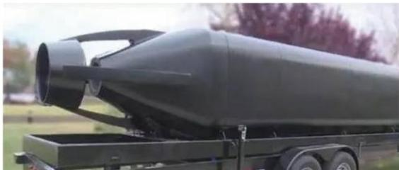
近日，美国橡树岭国家实验室（ORNL）与美国海军的颠覆性技术实验室（Disruptive Technology Lab）合作，开发出美军的第一个3D打印潜艇船体。这个30英尺长的碳纤维示范船体是用ORNL的大面积增材制造（BAAM）3D打印机打印的，一共只花了几分钟的时间。
