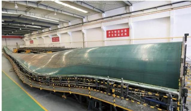
7月29日，由连云港中复连众复合材料集团有限公司自主研发的LZ68-4.0海上风电叶片在国内最大的风电叶片制造基地连云港工厂成功下线，该叶片长68米，为4.0MW主机配套，将安装在远海海域，且能抗台风。
