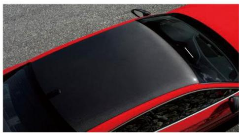
三菱化学株式会社宣布，其碳纤维复合材料已被用于生产奥迪运动有限公司于2017年6月推出的奥迪A5系列高级运动轿车型号RS 5Coupé的高循环压模（预浸料模压成型〔PCM〕）车顶。车顶使用PCM工艺制造，并由德国MCC集团公司Wethje Carbon Composites GmbH（以下简称“Wethje”）交付给奥迪。Wethje主要负责用碳纤维增强塑料（CFRP）生产汽车零部件。
