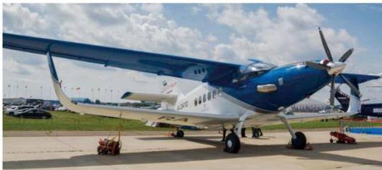
西伯利亚恰普雷金航空研究院在2017莫斯科航展上展示了一项科研成果，即TBC-2双翼飞机。TBC-2双翼飞机的外形很像我们从小就熟悉的An-2，但也仅仅外形相似而已。TBC-2是俄罗斯第一架完全使用复合材料的飞机。新材料的使用提高了飞机强度，可以完全杜绝支柱、斜立柱等支撑件。上下机翼的固定布局能多装燃油3500升以上，从而极大地提高了飞机航程。西伯利亚航空研究院的设计师们在设计飞机时还使用了数字化模拟方法，优化了飞机气动外形。
