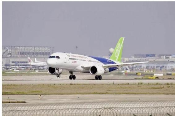
中国首架自主研发的国产大飞机C919在5月于上海试飞成功，它采用了多种碳纤维增强树脂基复合材料。
