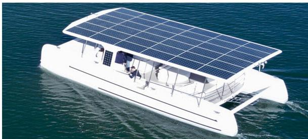
荷兰Soel游艇公司正式推出了SoelCat 12太阳能电动双体船。Soel游艇公司将这艘双体船称为“水上特斯拉”，它不需要燃油而且每年可以减少142吨二氧化碳，而传统的推进船每天要消耗200升的燃油。SoelCat 12可容纳16名乘客，是为咸水应用设计的，而且由于它具有用轻质玻璃纤维复合材料制成的增强船体结构，可以拖上沙滩。复合材料还让该公司达到了其船体所需的设计灵活性。
