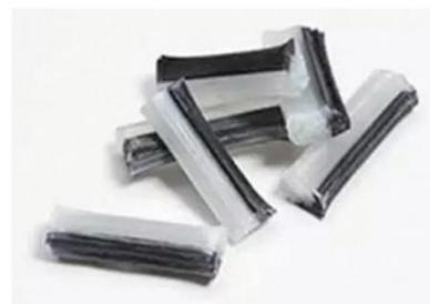
图1：12 毫米长的混合长玻璃和碳纤维复合颗粒。
