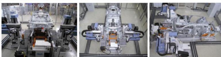
公司为保时捷研制的车身加工系统，焊接结束后对整个车体进行整体高
