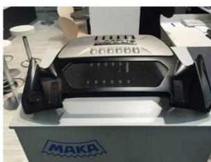
图为Lotus跑车发动机复合材料零件
