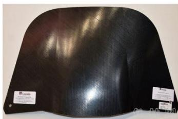
混合是生产高度灵活的热塑性预浸料的工艺。Concordia的独特工艺能密切融合连续纤维和连续长丝热塑性纤维来生产纱线，然后用纱线可以编织成织物。这些织物在加热和压力下可以被模压进入复杂的热塑性复合形状或管内。
