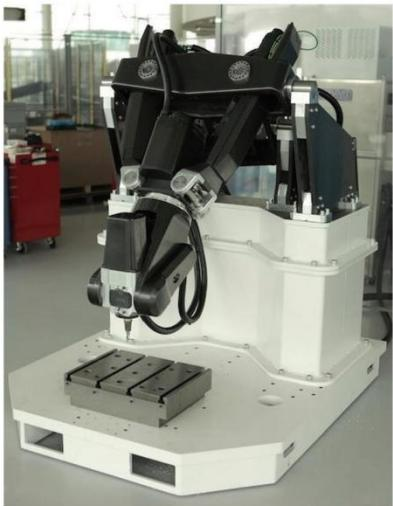
当今工业界绝大多数机器人使用串联联动技术，每个额外的轴都是安装在之前那个之上，机器人的终端执行器在最后一个轴上。并联运动机器人的终端执行器安装在2个或多个独立移动的机械臂上，允许执行器使用3个或更多并联轴在X、Y、Z方向移动。并联运动机器人可以向单臂机器人那样柔性移动，但精度和刚度更高，特别适合机加操作。
