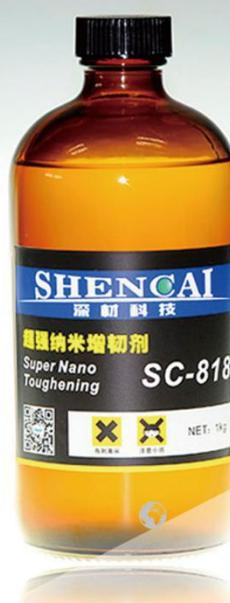
超强纳米增韧剂, 透明/浅黄液体、低粘度 (CPS: 10/20)、耐温度范围 (-50°C + 300°C)、耐多数化学介质 (包括防水和耐盐雾)。SC-818 超强纳米增韧剂与各类树脂无可取代的相容性和加工性能, 在保持树脂本体力学性能 (剪切强度、拉伸强度、拉伸模量、弹性模量、压缩强度、压缩弹性模量、弯曲强度、弯曲弹性模量) 稳定的基础上, 既提升各类树脂产品极佳的抗冲击性能和断裂伸长率 (6-8%), 又增强树脂对附着物的密着性, 也提供惰性基材表面的润湿和补强, 同时具有优异的耐候性和耐磨性。
