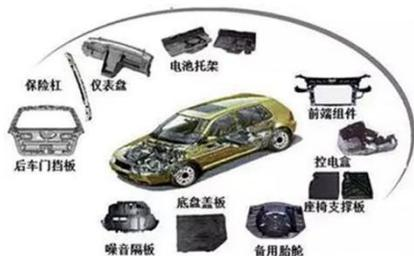
在汽车中应用的基于天然纤维复合材料的零件已超过40种,而国内外也开发出多种车用竹纤维增强复合材料,已经试生产的产品有内饰板、顶棚、行李厢、衣帽架、座椅背板、仪表盘、隔热/音和阻尼材料等。
