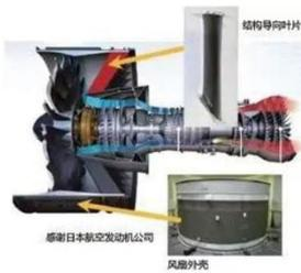
IHI公司与合作伙伴一起，开发出一种创新的轻质复合系统风扇外壳和第一个热塑性复合材料结构导向叶片 (SGV)。这项创新成功应用于由PW1100GJM发动机驱动的空客A320neo。该发动机于2014年12月获得FAA认证，而空客A320neo于2015年12月获得认证。
