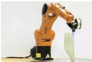
Atropos是第一个能够使用热固性树脂3D打印连续纤维复合材料的6轴机器臂的名称。这台3D打印机使用的是一种在树脂溶液浸泡过的纤维,当这种纤维从打印头中出来时在UV光的照射下会立即固化,这使我们能够制作出精确的形状、结构,而且还能将不同的纤维结合起来。该机器可以以精确和可重复的方式放置它们。
