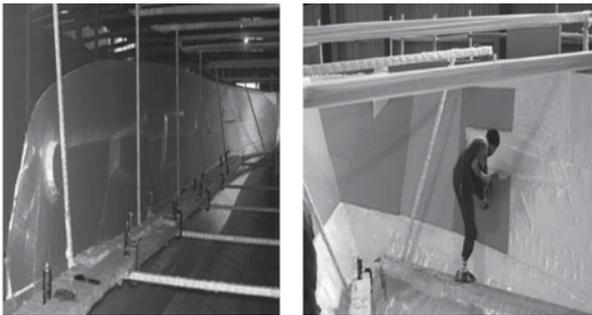
第四步：真空袋材料铺设先铺上脱模布，接着是导流布，最后是真空袋。在合上真空袋之前，要仔细考虑树脂和抽真空管路的走向，否则有的地方树脂会无法浸润到。铺设时要非常小心，以免一些尖锐物刺破真空袋。
