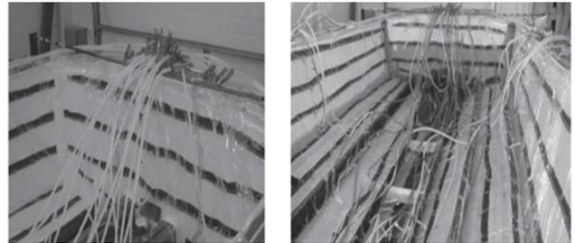
第八步：脱模树脂凝胶固化到一定程度后，揭去真空袋材料。从模具上取出制品并进行后处理。
