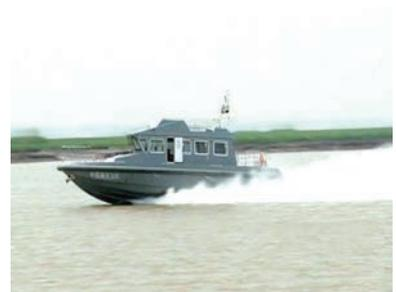
型，双柴油机驱动，双表面浆推进，主船体及上层建筑均采用高强纤维增强塑料。船长16.5米，设计定员10人，在满载排水量状态下，以巡航速度32节计算其续航力大于300海里，最大航速超过48节，性能十分出众。据不断改进，我国海关在役船艇最大航速约为40节，本艇交付使用之后，将成为中国海关航速最快的缉私艇。
