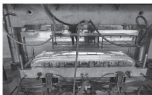
优普模具上下模都采用油加热或者 蒸汽加热。油管采用油路快速接头 联结，可以非常方便的联结和断开
