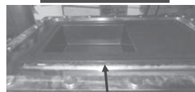
优普模具的产品飞边薄而均 匀，飞边用砂纸即可擦掉。
