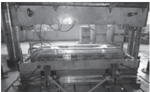
优普模具全部采用液压油缸顶出系统
