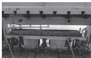
1、模具上有高于产品面的 导柱导套做第一级导向系 统，以保证模具上下模合 模准确、安全。
