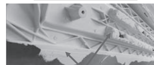
上面剪切边对应的产品：飞边严重偏厚偏 大，浪费材料、修边困难，成本增加
