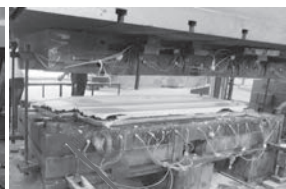
只有很细的粗导，上下模之间无有效定 位和安全保护，铺料不均匀会造成模具跑 偏，局部飞边加大，材料外溢，产品失 压导致强度不好也浪费材料。
