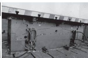
模具上、下模未装隔热板，上、下 模的高温直接传递到了压机板上。
