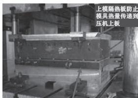
下模隔热板防止模具热 量传递到压机下板
