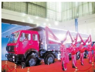
我国首台配备碳纤维全复合材料车厢的自卸车近日在内蒙古包头下线,该车长8.6米,载重50吨,自重4.8吨,比金属厢体减重29%。这是复合材料在国内重卡车厢中首次成功应用,意味着我国复合材料在汽车轻量化领域的应用技术有了新的突破。
