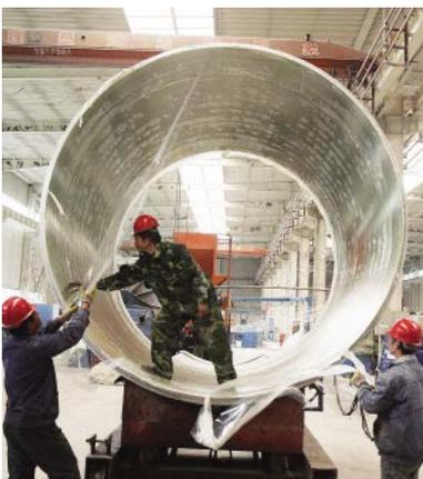
近日，由天津市建材集团龙泓复合材料公司自主研发的国内口径最大的2.8米玻璃钢顶管开始生产，将用于纪庄子污水处理排水工程。
