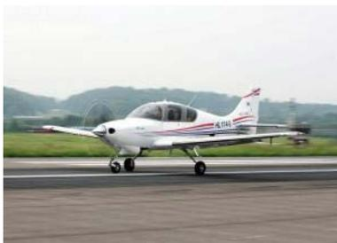
滨奥飞机制造有限公司是国内唯一中外合资生产全复合材料机体的飞机制造商，由于采用复合材料，每架
