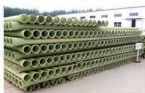
缠绕管道树脂
