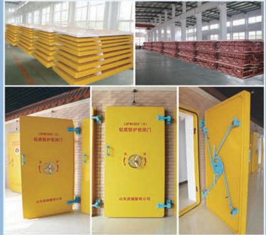
该门密闭性能良好，具有重量轻、强度高、耐腐蚀、寿命长等优点，以及良好的绝缘性、隔音性和阻燃性。完全可以替代现代的钢筋混凝土密闭门和全钢密闭门。复合材料轻质密闭门还具有环保性、没有维修费用、易于批量生产等特点，可以在人防建设中发挥重要作用，同时用复合材料轻质防护密闭门替换一些年久失修以致损坏的钢筋混凝土密闭门，安装方便、省时省力，可以有效保证人防工程效能的实现
