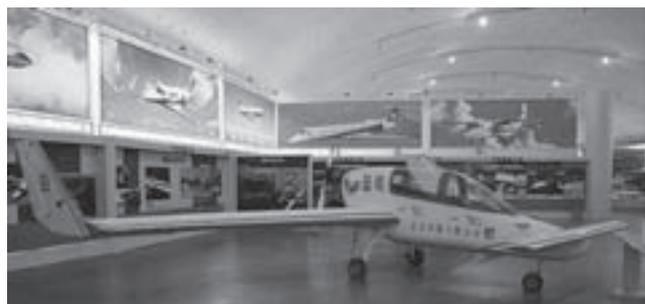
AD200飞机很适于航空运动、教练、空中旅游和巡逻，经简单改装可作农林、空中摄影等专用机。AD200飞机采用的是国际先进的鸭式气动布局，其优越性在于全机不会失速，不会进入螺旋。机体全部采用玻璃钢结构，85%为复合材料，在某种意义上讲，具有一定的隐形作用，一般很难被雷达发现。
