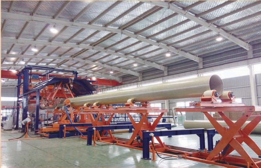
连云港唯德复合材料设备有限公司成立于2001年。公司致力于复合材料产品缠绕设备的研究及制造，是国内唯一一家既能为航天、军工、核工业提供高精度缠绕机，又能为民用提供通用型纤维缠绕机及整套生产线的企业。2014年6月我公司生产的连续纤维缠绕生产线一投入运行。产品应用领域主要包括玻璃钢管道、化工储罐以及车载高压气瓶等。公司具有复合材料设备设计、制造及安装的一整套人才体系，主要技术与武汉理工大学合作并建立紧密的科研生产一体化。
