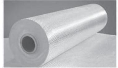
软的,适合成型复杂形状,每平方米750克或1500克,颜色为天然色或黑色。层压、模塑或拉挤工艺建议在400°F的温度,冷压适合20-100 PSI。具有无限的寿命PolyPreg不需要冷藏,可以承受的温度高达300摄氏度,耐紫外线,该材料在阳光暴露下,也可保持其颜色和形状,不易变脆,裂纹或变色。此外,PolyPreg不会产生辐射,完全可回收。
