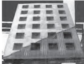
图14 纺织品增强的开孔三维混凝土构件
