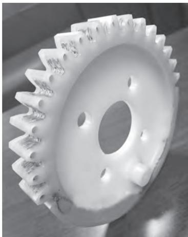
日本岐阜大学模具创成技术研究中心和CentralFineTool公司共同开发出了利用碳纤维织物强化的树脂齿轮。通过实际使用这种齿轮，替代汽车等配备的金属齿轮，有望实现轻量化，降低生产成本并延长产品寿命。
