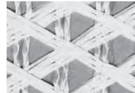
图4 三轴向经编玻纤织物照片
