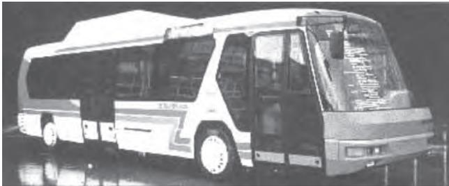
图22 用多轴向经编织物制成的汽车外壳
