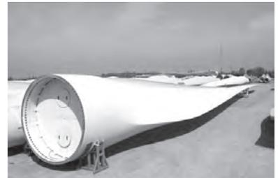
为了适应巨型叶片的生产，中复连众对叶片厂房做了局部加高提升；对打孔设备做了能力改造以满足打孔需求；叶片模具采用进口电加热系统，控制稳定，具有很强的抗静电干扰性能；装备的进口液压翻转系统，能够在7分钟内实现模具的开合；开发了更加安全可靠的真空脱模吊装系统用于根部插件的脱模吊装。碳纤维大梁预浸料采用先进的铺覆工装保证了铺设精度，精细的控制工艺和合理的固化制度，将碳纤维的孔隙率控制在1%以下。
