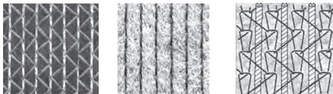
(a) 织物正面 (b) 织物反面 (c) 织物结构示意图
