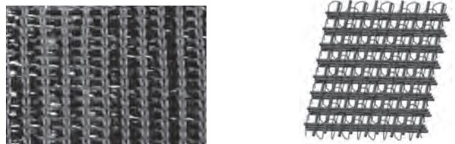
图27 罗纹捆绑纬编多层双轴向织物
