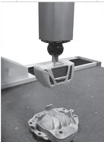
激光扫描仪的制造商Perceptron公司日前推出世界上第一台绿色激光线通用CMM机扫描仪，用于高反射材料，如碳纤维复合材料。
