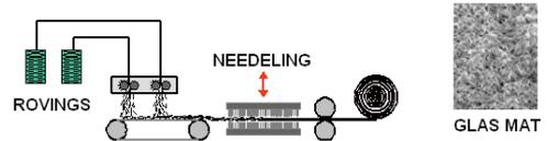
短切玻纤针刺毡生产工艺示意图
