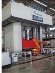
海源公司全自动热塑性复合材料压机
