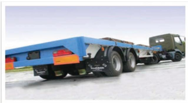
图1用RTM法生产的50M2大的半挂车底板
